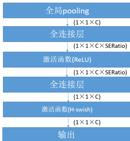
图 3-6: mobilenet v3 SE 模块中的激励部分
