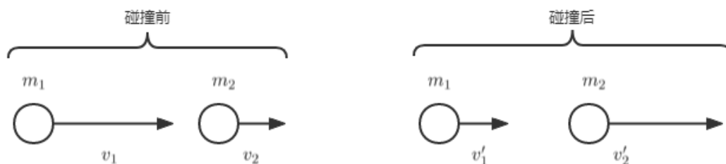
图 3-1 一维弹性碰撞的物理模型。两物体碰撞后，它们的速度发生相应变化。
