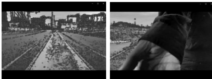
图 4-10 遮挡判定：当摄像头被遮挡时，某些区域的特征点数量会大幅降低
