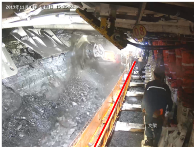
图 5-1: 采煤机正在运行的工作面场景照片及安全区划分示意
